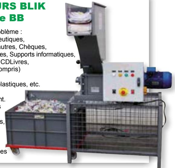
**BROYEURS BLIK B400 & B600, de 3 à 18 kW, la triple réduction de volume pour détruire, et réduire le volume des déchets volumineux et rigides**
