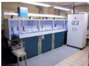
Cette ligne modulaire à ultrasons est conçue pour le nettoyage de pièces après différentes étapes de production et au stade final. Elle repose sur une technologie innovante et écologique, intégrant les étapes suivantes : chargement, nettoyage à ultrasons avec processus lessiviel, rinçage en eau courante, rinçage en eau pure, séchage et déchargement.
