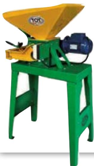
Aplatisseur et laminoir, pour produit sec de 2.2kW à 30kW
