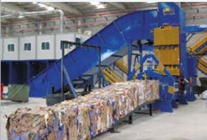
Une gamme de presses à balles à ligaturage automatique et semi automatique capable de gérer des gisements allant jusqu'à 15 tonnes par heure. Nos équipements sont reconnus pour leur robustesse et fiabilité dans 75 pays du monde !
