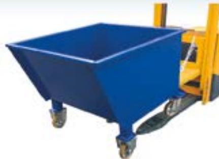
Benne basculante manuelle (BBM)
