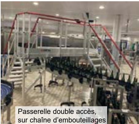
Passerelle double accès, sur chaîne d'embouteillages
